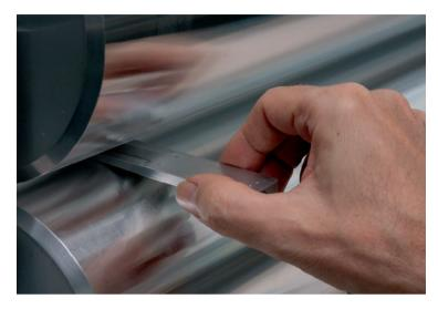
Die Spaltweite wird nach dem Loslassen des Messkeils am Display abgelesen.
